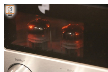
內置膽管12AX7A及12AX7B，音色溫暖舒服，機面設有透明玻璃，用家能睇到機內發光的膽管。
